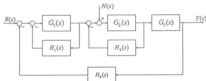
二、(15 分)已知某系统的结构图如下图所示，若要求系统阶跃响应的性能指标满足：超调量  $\sigma\% = 20\%$ ，调节时间  $t_s = 1.8s (\Delta = 5\%)$ 。
